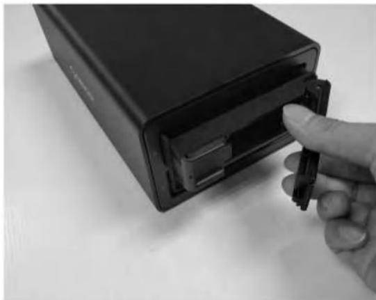
3. Установите 2.5" /3.5" SATA HDD/SSD, зафиксируйте винтами.
