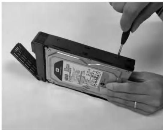
3.5" жёсткий диск (фиксируется 4 болтами с двух сторон)
