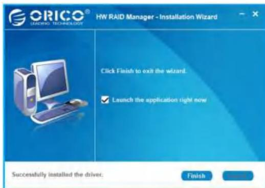
3. Ярлык программного обеспечения ORICO HW RAID Manager появится на рабочем столе ПК после завершения установки. Включите питание устройства и жестких дисков, дважды щелкните, чтобы запустить программное обеспечение для настройки или управления RAID.
