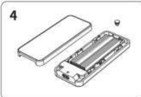
Затяните силиконовый винт, чтобы зафиксировать SSD.
