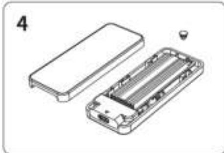
Затяните силиконовый винт, чтобы зафиксировать SSD.
