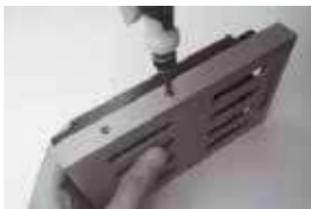
Шаг 3: вставьте лоток обратно в корпус док-станции, зафиксируйте крышку с помощью винтов.
