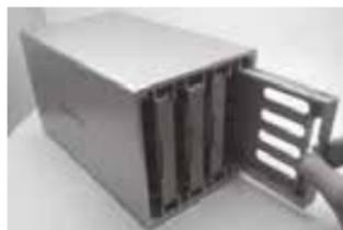
Шаг 2: установите жёсткий диск в лотке и закрепите его с помощью четырёх винтов.
